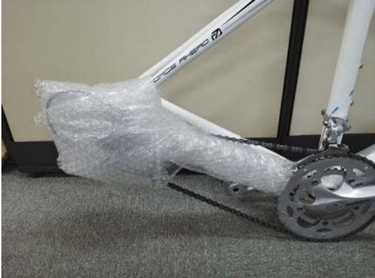
Put the padding around derailleur
